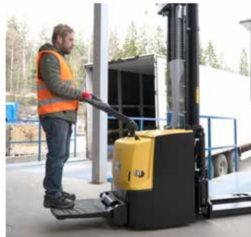
Las opciones de conducción programables ahorradoras de energía, la construcción robusta y la alta resistencia al agua y la suciedad reducen los costos de funcionamiento y aumentan la productividad. Las necesidades de mantenimiento se minimizan por medio de un sistema de elevación y conducción integrado, con menos componentes y acceso rápido a todas las partes principales del montacargas.
